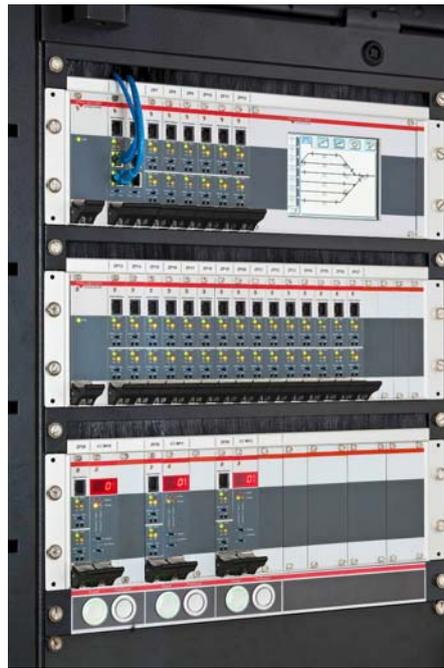
Das Achszählsystem mit Ethernet-Anschluss besteht aus der Auswertebaugruppe mit der Zählpunktauswertung und dem Achszählalgorithmus sowie der Kommunikationsbaugruppe.
