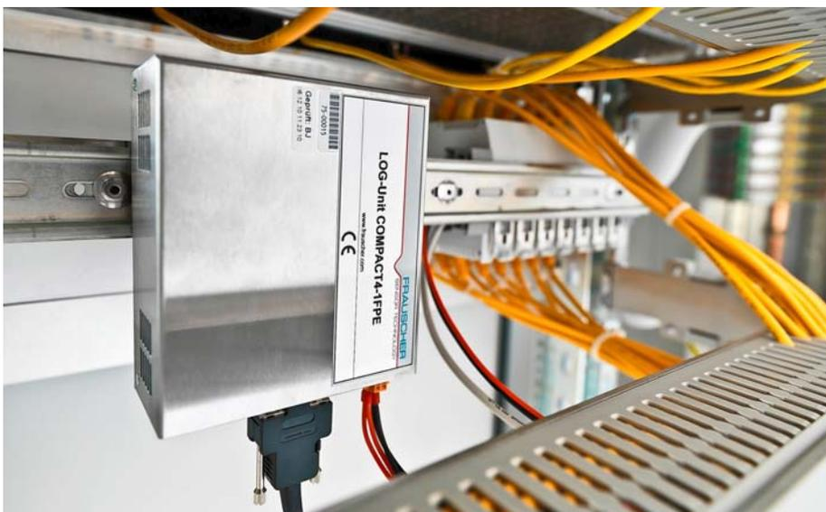
In sämtlichen Achszählsystemen werden die Rechner von Syslogic zur Steuerung des Diagnosesystems eingesetzt.
