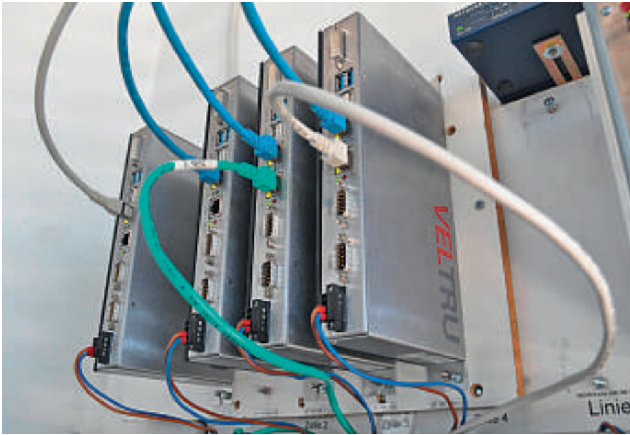
Testaufbau mit den Syslogic-Steuerrechnern im Hauptsitz von Veltru in Feuerthalen
