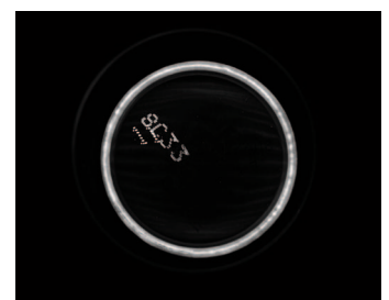
Bild 3: Eine Getränkedose, markiert mit fluoreszierender Bedruckung. Zunächst wird die Position der Dose am leuchtenden Ring erkannt, im zweiten Schritt der firmeninterne Code gelesen.
