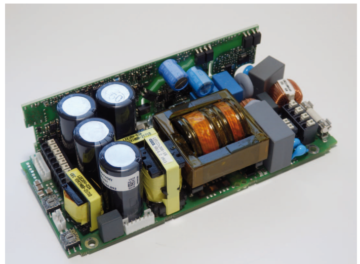
PSU-0164-09: 150 W 4-Kanal LED Treiber mit universellen Steuerungsmöglichkeiten mit modularem Konzept
