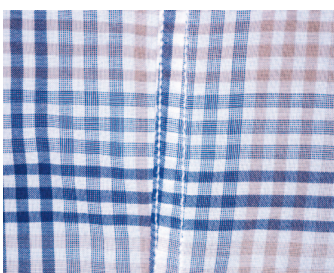
Bild 2: Die Aufnahme eines Hemdes. Unter weißem Licht sind Farbmerkmale detektierbar, unter IR-Licht wird die Farbe ausgeblendet und die Struktur kommt zum Vorschein.
