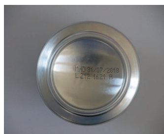
Bild 3: Eine Getränkedose, markiert mit fluoreszierender Bedruckung. Zunächst wird die Position der Dose am leuchtenden Ring erkannt, im zweiten Schritt der firmeninterne Code gelesen.
