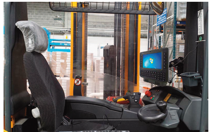
Bild 4: Für den harten Industrialltag: Die robusten Vehicle Mounted Computer FM08 und FM10 sind speziell für den Einsatz im rauen Umfeld von Logistikzentren konstruiert und lassen sich nahtlos in z. B. Gabelstapler integrieren
