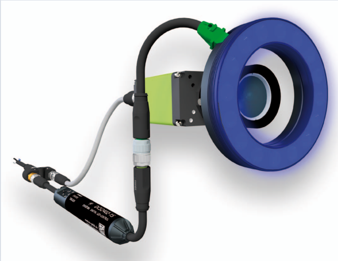
Digitale LED-Beleuchtungscontroller mit Vierseitenbeleuchtung: Die evotronLIGHT-Technologie ermöglicht einfaches Systemdesign und exzellente Leistungsdaten gleichzeitig. Konstante Lichtenergie und Blitzzeiten von 1 \mu s bei max. 500 kHz Blitzfrequenz sind möglich. (Bild: evotron GmbH & Co. KG)
