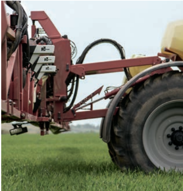
Drei Sensorköpfe am Spritzgestänge eines Pflanzenschutz-Sensorsystems.
