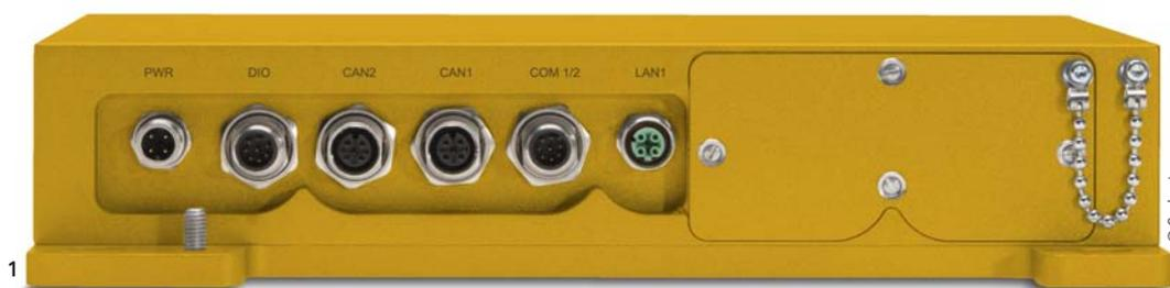
1 Die lüfterlosen Industrierechner der Rugged-Computer-Linie bilden ein robustes Embedded System mit IP67-Schutz.
