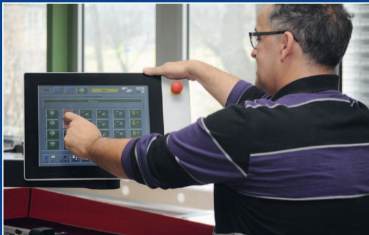
Die kundenspezifischen Panel-PCs lassen sich auch mit Notaus-Schalter ausstatten.
