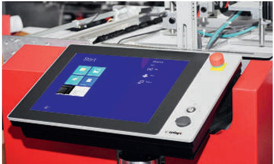
Ein Syslogic-Panel läuft unter dem Betriebssystem Windows Embedded 8
